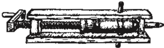
c) Primitive Wurstmaschine mit integriertem Blechtrichter (L 135 cm, B 31 cm, H 20 cm)
