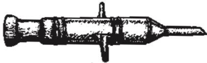
b) Blechtrichter mit Holzstößel und seitlichen Griffen (Länge 57 cm, Breite inkl. beide Griffe 26,5 cm, Durchmesser 8,5 cm)
